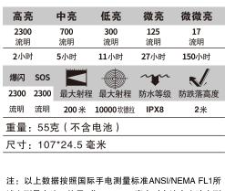
述之测量方法,使用1节3.6V 3500毫安时电池在实验室测 试所得。不同电池或使用环境可能对以上数据造成影响。 手电有温控程序,会自动调节电流,保护LED和电池。
